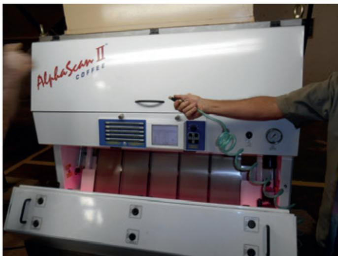
Figura 7. Higienização de selecionadora eletrônica com ar comprimido.
